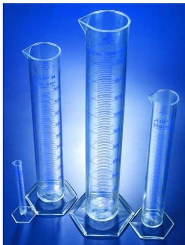
Eprouvettes graduées en polyméthylpentène (TPX) transparent autoclavable.
